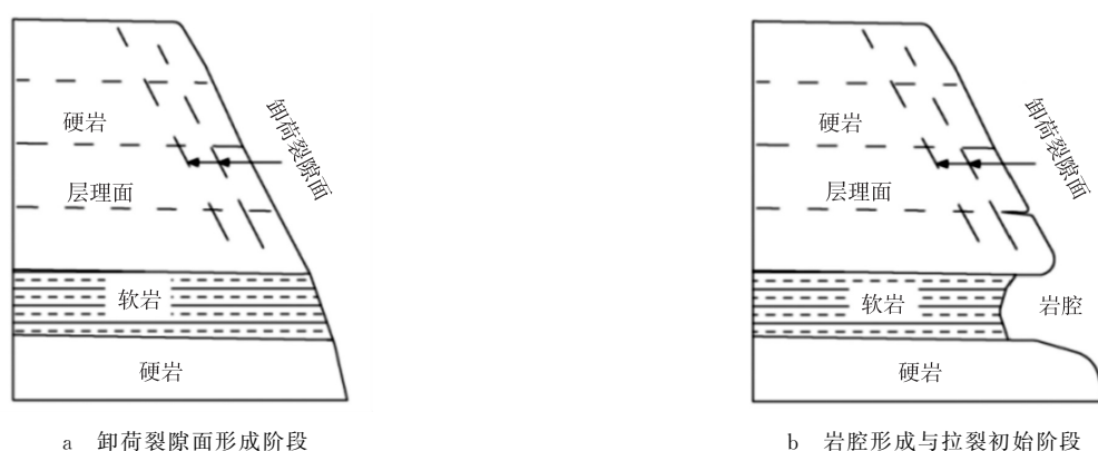
图1 含断续较陡倾裂隙的近水平岩层地质演化模型
